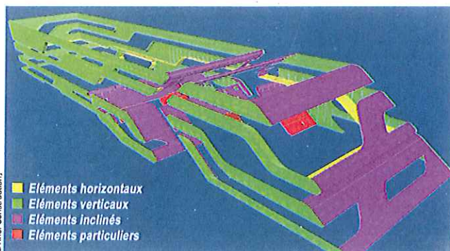
Schéma I – Répartition des différents types de pièces préfabriquées destinées à l'habillage des façades.
